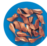
C1020 EX-SUS-GDR ø 8,5 Velocidad: 32 m/min. Avance: 0,24 mm/rot.
