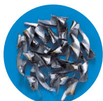
SCM440 VP-GDR ø 8,5 Velocidade: 32 m/min. Avanço: 0,24 mm/rot.
