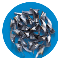
SCM440 VP-GDR ø 8,5 Velocidad: 32 m/min. Avance: 0,24 mm/rot.
