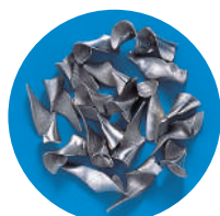
SUS304 EX-SUS-GDR ø 8,5 Velocidade: 18 m/min. Avanço: 0,2 mm/rot.
