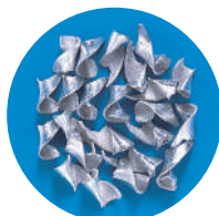
A7075 EX-SUS-GDR ø 8,5 Velocidad: 50 m/min. Avance: 0,45 mm/rot.
