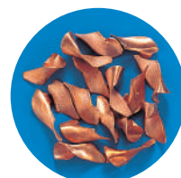
C1020 EX-SUS-GDR ø 8,5 Velocidade: 32 m/min. Avanço: 0,24 mm/rot.
